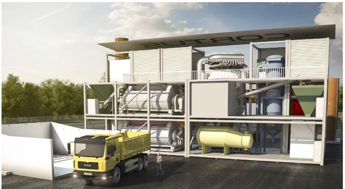
3D datordesign för 6 MW modulär WoodRoll®
